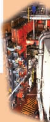
JET – urządzenie do nagrzewania plazmy wiązką atom
