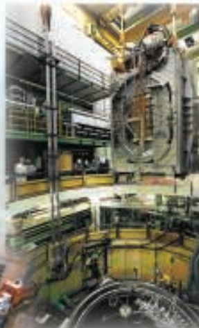
Testowanie prototypu cewki pola toroidalnego
